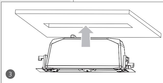
4 Fissare il diffusore acustico al pannello del controsoffitto avvitando le due viti (una per lato, vedere le figure) dei morsetti di bloccaggio tramite un cacciavite.
