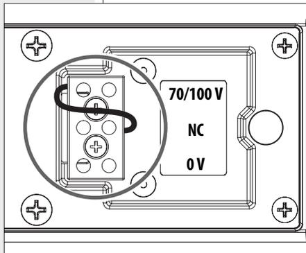
I due morsetti ("70/100V" e "0") permettono il collegamento sia del cavo d'ingresso sia di quello d'uscita per la connessione in parallelo di altri diffusori acustici.
