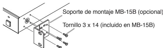
**Paso 2.** Monte el aparato en el rack, utilizando para ello los tornillos que se suministran con el kit MB-15B.
