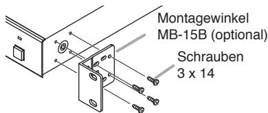
**Schritt 2.** Montagewinkel am Gestellschrank befestigen.
