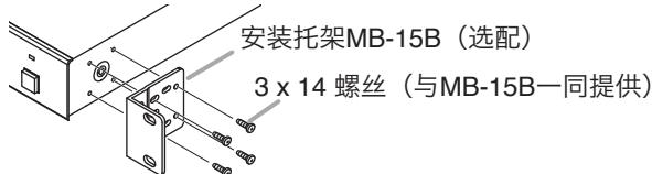
**第2步** 使用与MB-15B一同提供的其他螺丝, 在机架中安装设备。
