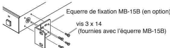
**Étape 2.** Utiliser les autres vis fournies avec l'équerre MB-15B, puis monter l'appareil dans le rack.
