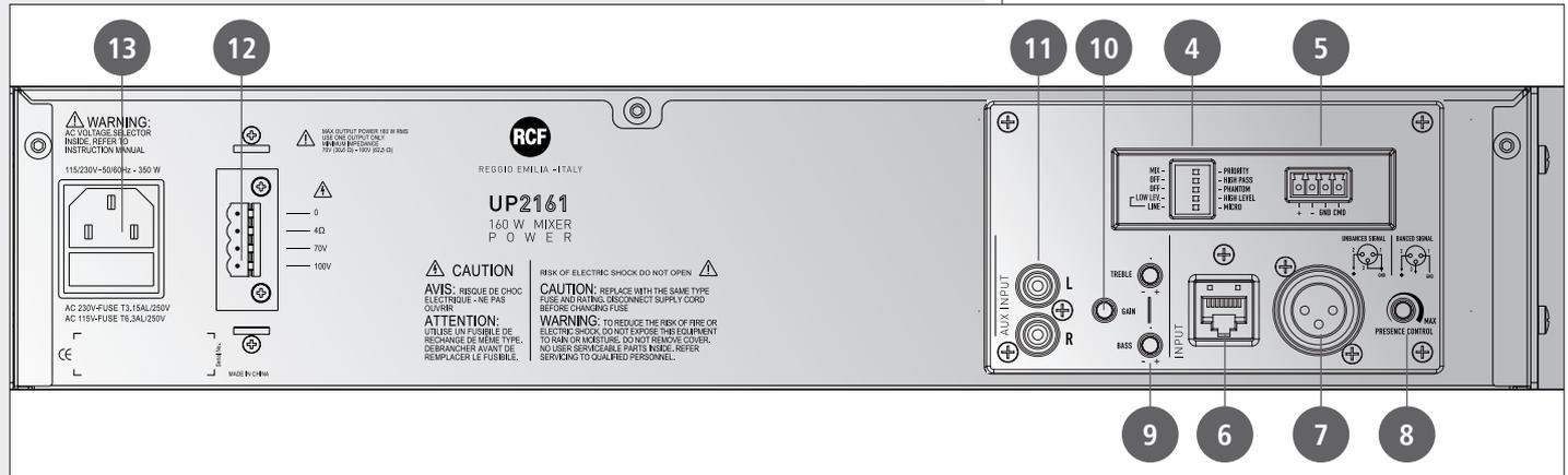
**4** Impostazione dell'ingresso **MAIN INPUT** tramite 5 microinterruttori "dip-switch":
