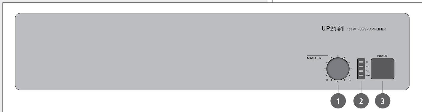
1 Controllo di volume principale (**MASTER**) dell'amplificatore.
