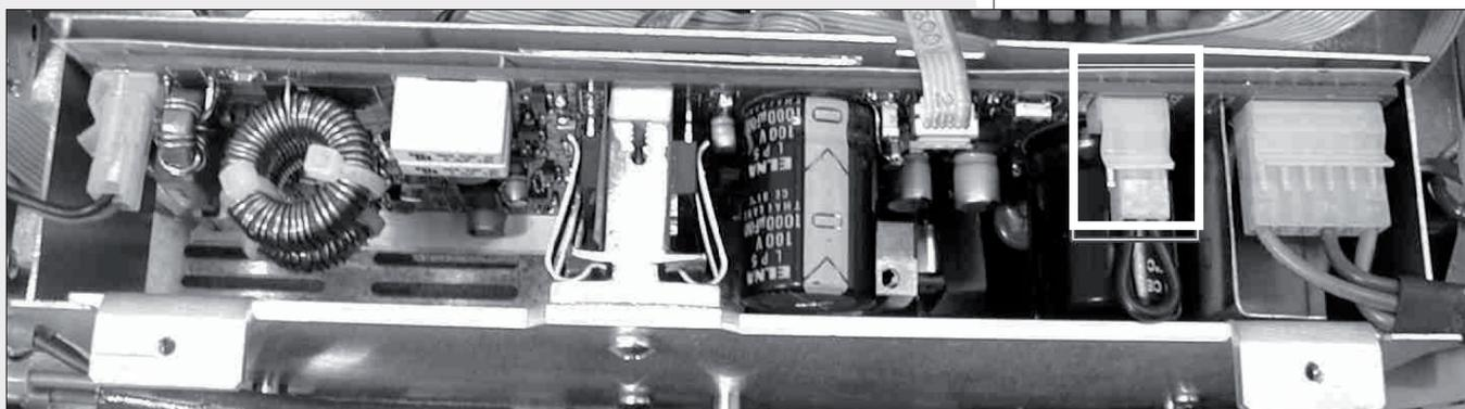
Individuare il connettore per il cambio di tensione 230 / 115 V dell'alimentatore (nella foto 1 è evidenziato con un quadrato).
