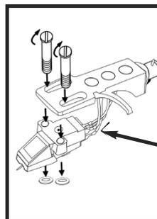
Veillez relier l'ensemble des fils du porte-cellule à la cellule. Pour plus de facilité, les connecteurs de chaque cellule possède une couleur différente. Re-liez chaque fils en respectant ce code couleur. Si la cellule possède pas de code couleur, les bornes positives (+) sont celles situées en haut et les bornes (-) celles du bas. Les fils connectés du côté gauche concernent le canal gauche. Les fils situés à droite concernent le canal droit.
