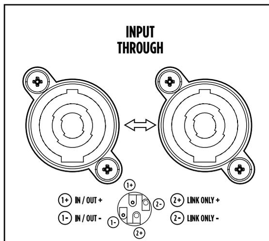
Collegare il conduttore positivo (uscita “+” dell’amplificatore) al contatto “**IN / OUT+**” del connettore SPEAKON a 4 poli; collegare il conduttore negativo (uscita “-” dell’amplificatore) al contatto “**IN / OUT -**” del connettore SPEAKON a 4 poli. I contatti “**LINK ONLY +**” e “**LINK ONLY -**” sono utilizzabili per un eventuale collegamento (in parallelo) di un altro subwoofer.
