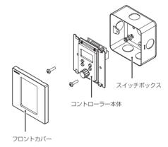
フロントカバーを外すときは、フロントカバー上下にある切り欠きにマイナス ドライバーなどで挿して持ち上げると取り外せます。このとき、フロントカバー が破損しないようにご注意ください。
