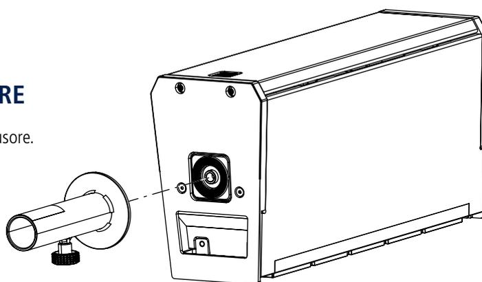
Una volta che il pole mount kit è ben stretto al diffusore è possibile montarlo su un supporto a stand o su un subwoofer.
