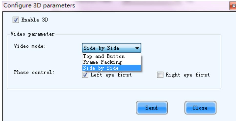
Fig. 5-35 Configure 3D parameters
