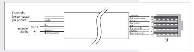
Importante: per attivare la porta RJ 45, è necessario porre a massa il comando per la priorità (ad esempio, tramite il pulsante della base microfonica BM 3001).
