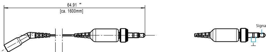
Kabel mit 3-poligem Spezialstecker / cable with 3-pin special connector
