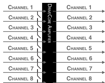
Abb. 4.6.2 Acht Kanäle ohne Eingangs-Routing
