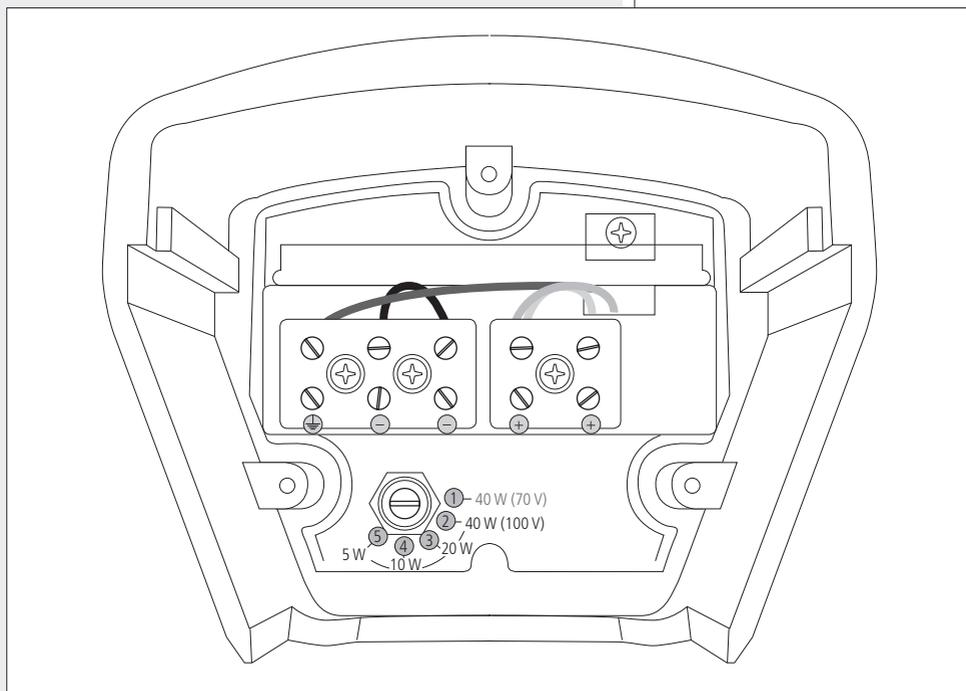
I collegamenti con la linea audio si realizzano tramite i morsetti ceramici presenti all'interno (occorre rimuovere il fondo svitando le sue tre viti). I morsetti + e - permettono il collegamento sia del cavo d'ingresso sia di quello d'uscita per la connessione in parallelo di altri diffusori acustici.
