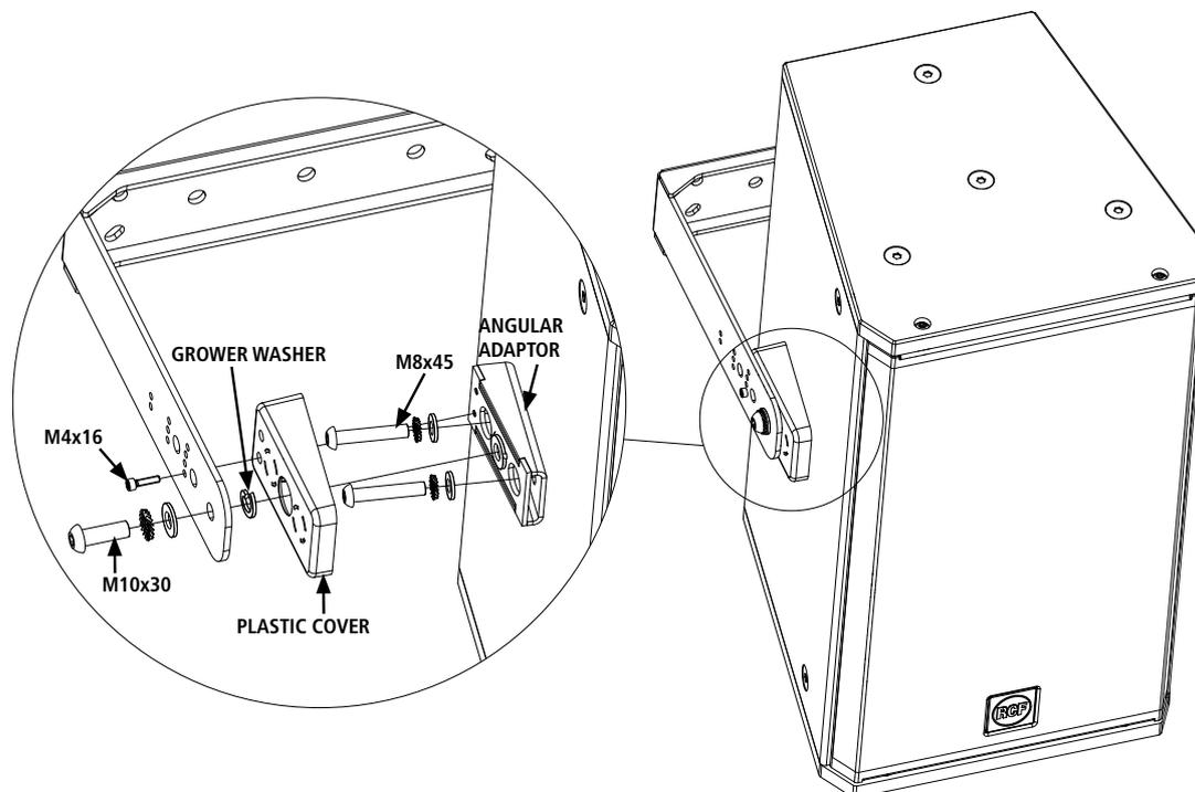
1. Dopo aver rimosso le viti avvitate alle pareti laterali del diffusore, fissare l'adattatore angolare sul diffusore tramite le viti M8x45.
