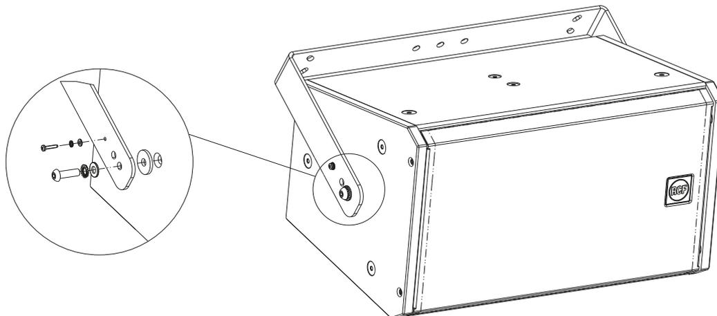
Come alternativa, è possibile un'installazione un po' meno sporgente grazie ai fori più interni della staffa ad U. Prima di stringere i due bulloni M10, regolare l'inclinazione verticale del diffusore e successivamente (quando si è certi dell'angolo) fissarla tramite due viti autofilettanti M4,2x22 (passanti per il foro piccolo della staffa a U) direttamente nel legno del diffusore.
