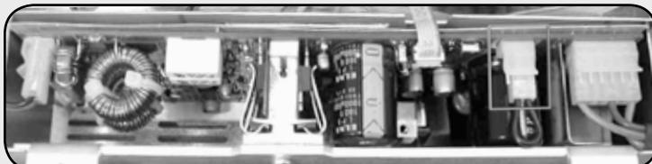
Si la tension secteur est 230 volts, placez le connecteur en position 230Vac (voir image 2) en respectant les indications inscrites sur le circuit imprimé (en regardant le connecteur de face, la broche centrale est connectée à la broche droite).
