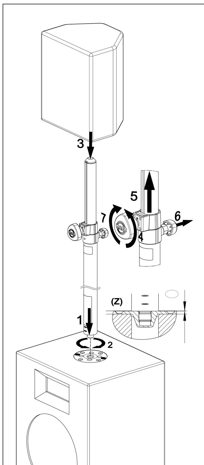
Die Klemmschraube muss vor der ersten Verwendung einmalig in die Spannschelle eingeschraubt werden.
