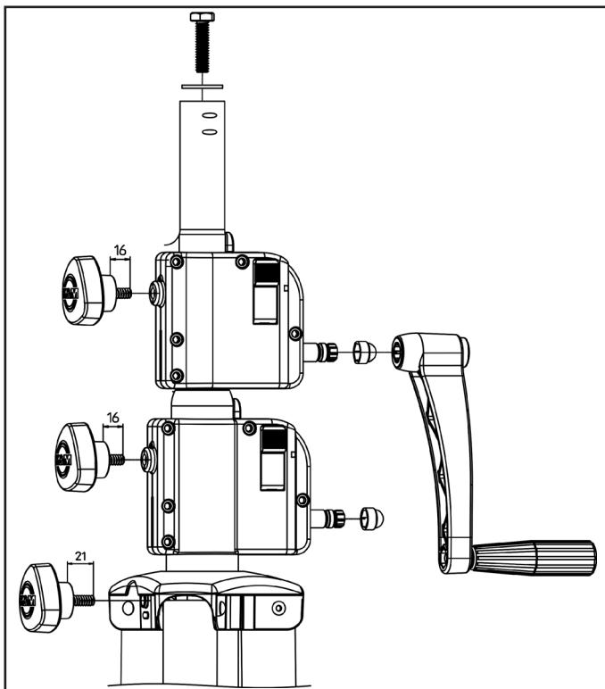
Die Klemmschrauben müssen vor der ersten Verwendung einmalig in das Kurbelgehäuse und die Fußschelle eingeschraubt werden.
