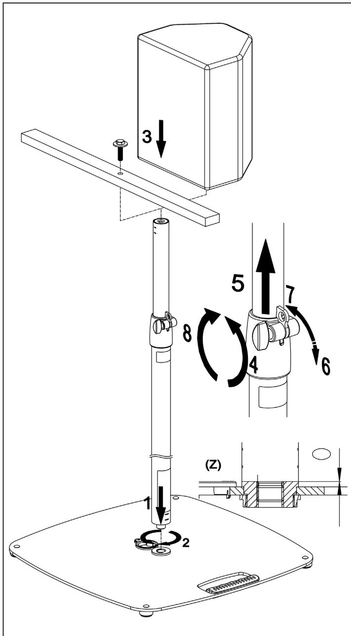
2.) Distanzrohr auf Basis montieren.
